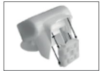
Abb. 11 Gehäuse von oben in den montierten Halter schieben. Die Zapfen des Halters müssen dabei in den Schienen des Gehäuses einrasten.
